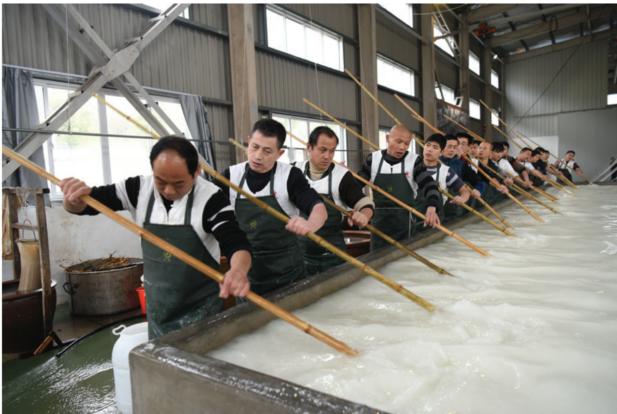
宣纸制作中的搅浆工序 Rühren des Faserbreis bei der Herstellung von Xuan-Papier
