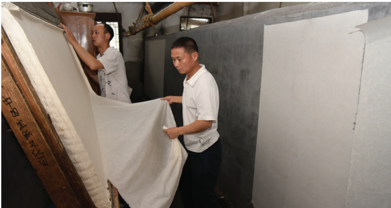
宣纸制作中的“揭纸贴焙”工序 Ablösen und Aufbringen zum Trocknen bei der Herstellung von Xuan-Papier
