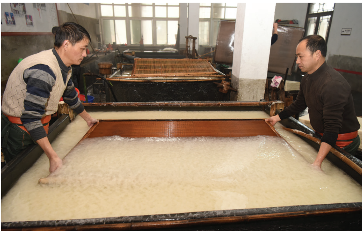
宣纸制作中的“抄纸”工序 Schöpfen des Papiers bei der Herstellung von Xuan-Papier
